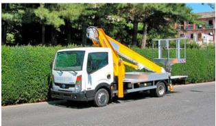
Nacelle sur véhicule léger pour vos travaux en hauteur nécessitant des déplacements fréquents.
