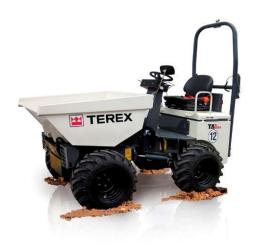
DUMPER hydrostatique articulé AUSA ou TEREX à déversement frontal.
