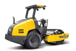
Compacteur monocylindre pour vos chantiers de compactage de plate-forme, construction routières et autoroutière ...
