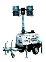
Le mat d'éclairage permet d'assurer de façon autonome la diffusion de l'éclairage sur vos chantiers de nuits.
